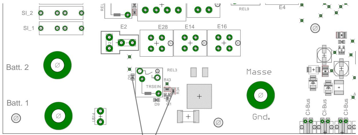
Um das Laderelais totzulegen muss entweder R34 oder D5 entfernt werden
