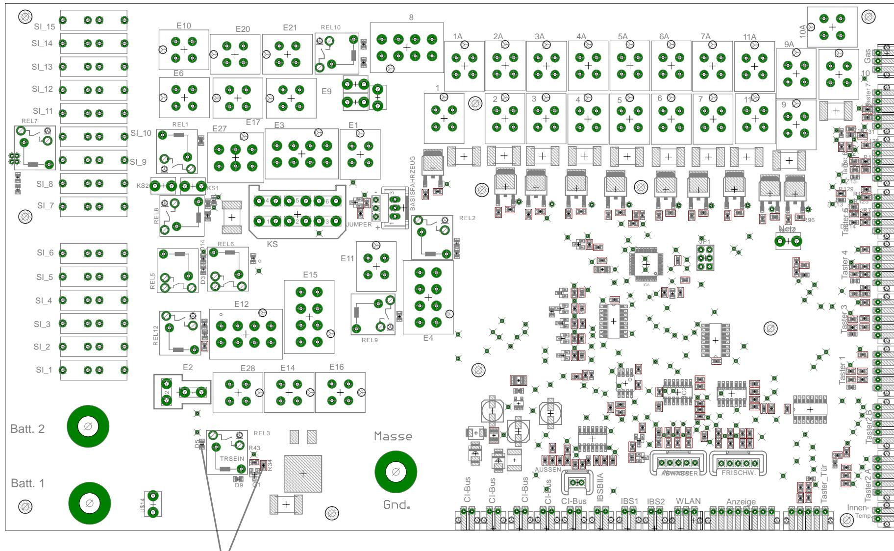
Um das Laderelais totzulegen muss entweder R34 oder D5 entfernt werden
