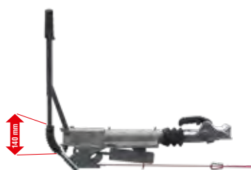
Levier de frein fermé (frein de parc vers l'arrière, frein réglé de manière optimale)
