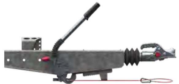
Levier de frein fermé (frein de parc vers l'avant)
