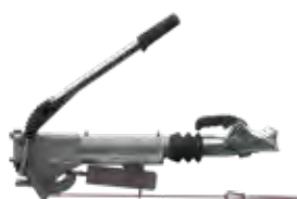
Levier de frein fermé (frein de parc vers l'avant)
