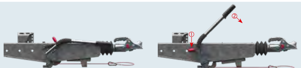
Levier de frein desserré = tringle de frein non actionnée
