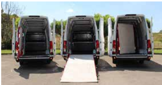
Gestraald anti-slip aluminium oppervlak
