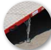
Zelfpositionerende verstelbare poten
