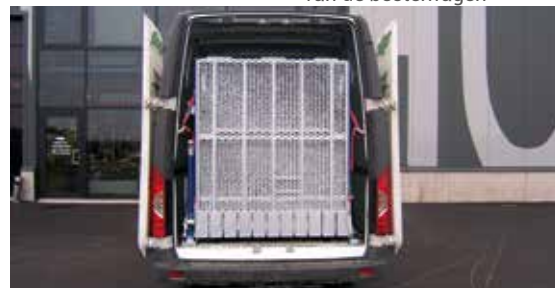
Beweegbare aanlegplaat voor perfecte aansluiting op de vloer van de bestelwagens
