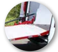
Beweegbare aanlegplaat voor perfecte aansluiting op de vloer van de bestelwagen
