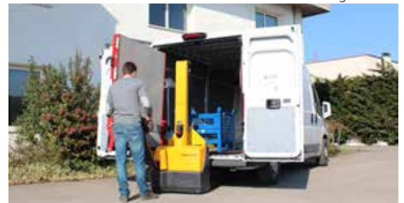
Beweegbare aanlegplaat voor perfecte aansluiting op de vloer van de bestelwagen
